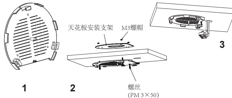
5. 将在GWN7605AP的箭头与安装支架的锁定选项卡上的箭头对齐。确保您的GWN牢固地安装在支架上并连接上了网络 and 电源线。
