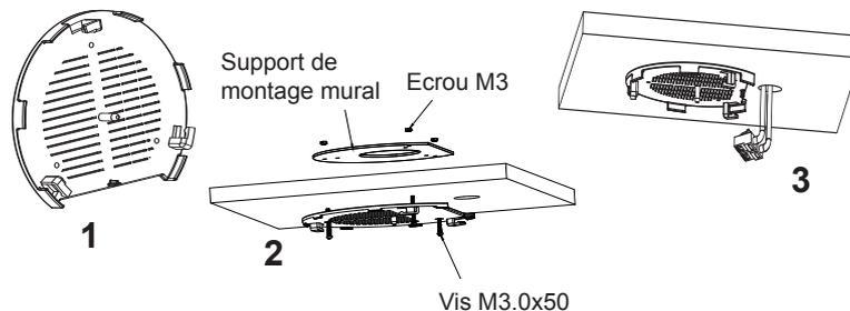
3. Insérer les vis dans le support de montage.
