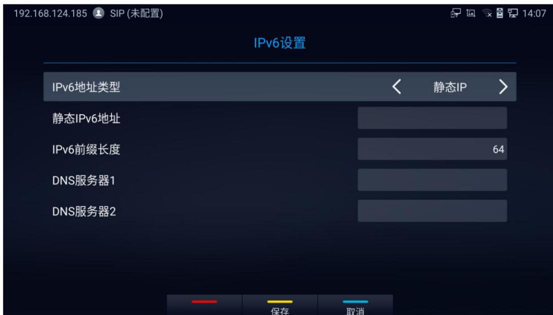
图 22 IPv6 设置-静态 IP
