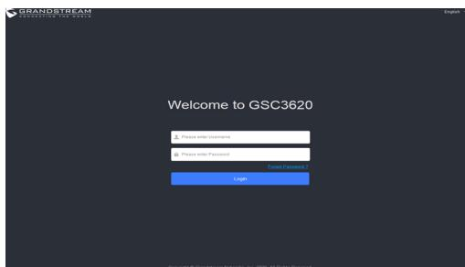
6. Le nom d'utilisateur et le mot de passe sont nécessaires pour se connecter à la caméra afin de gérer le périphérique. Le nom d'utilisateur par défaut est «admin»; le mot de passe par défaut est un mot de passe aléatoire imprimé sur un autocollant qui se trouve dans le boîtier de l'appareil photo et à l'arrière du QIG.
