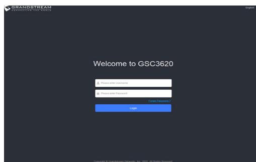
6. Login e password sono necessari per accedere alla telecamera per gestire il dispositivo. Il Login predefinito è "admin"; la password predefinita è una password casuale stampata in un adesivo che può essere trovato nel corpo della fotocamera e sul retro del QIG.
